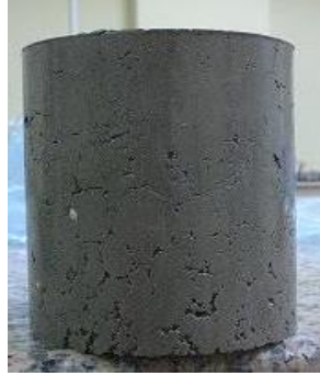
Şekil 3. Sıkıştırma işlemi yapılmış bir zemindeki hava boşlukları
